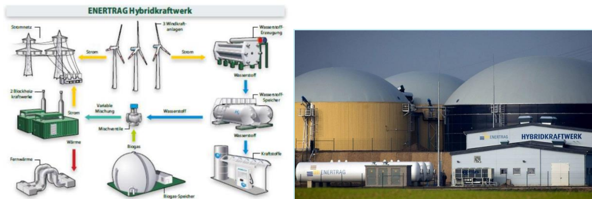
Figur 8. Ett eksempel på hydrogenproduksjon fra kraft i Tyskland. Overskudds vindenergi benyttes til å produsere hydrogen, som i dette tilfellet blandes inn i biogass for kraftvarme-produksjon.
