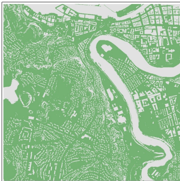
Figur 20: Binært kart – grått er områder uten mulighet for ferdsel pga naturgitte og bygde barrierer. Elva og kanalen har flere mulige krysninger, men slike behandles som egne lag i modellen, og overstyrer barrierelaget.
